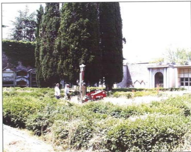
**FOTO N°2:** ESECUZIONE PROVA PENETROMETRICA N°2 ED AREA DI INDAGINE VISTA DA NORD.
