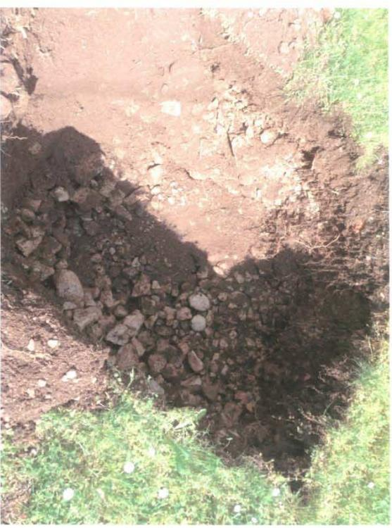
FOTO 3: Pozzetto P2 vicino al viale di accesso. Riporti non consolidati per 1,5 m costituiti da ciottoli in matrice ferrigena
